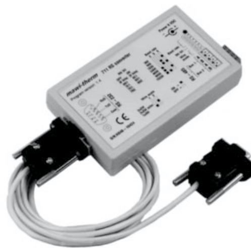
Der Konverter 711 wurde entwickelt um die serielle RS-232 Schnittstelle eines PC für Endgeräte mit RS-485 Schnittstelle zu nutzen. Die RS485/RS232-Umsetzung ermöglicht den Aufbau eines Datenerfassungssystems, an das verschiedene Endgeräte angeschlossen sind. Die Übertragung kann über eine Strecke von max. 1000 m erfolgen.
