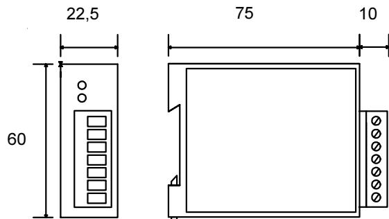
Steckbare Klemmanschlüsse 1,5 mm<sup>2</sup>
